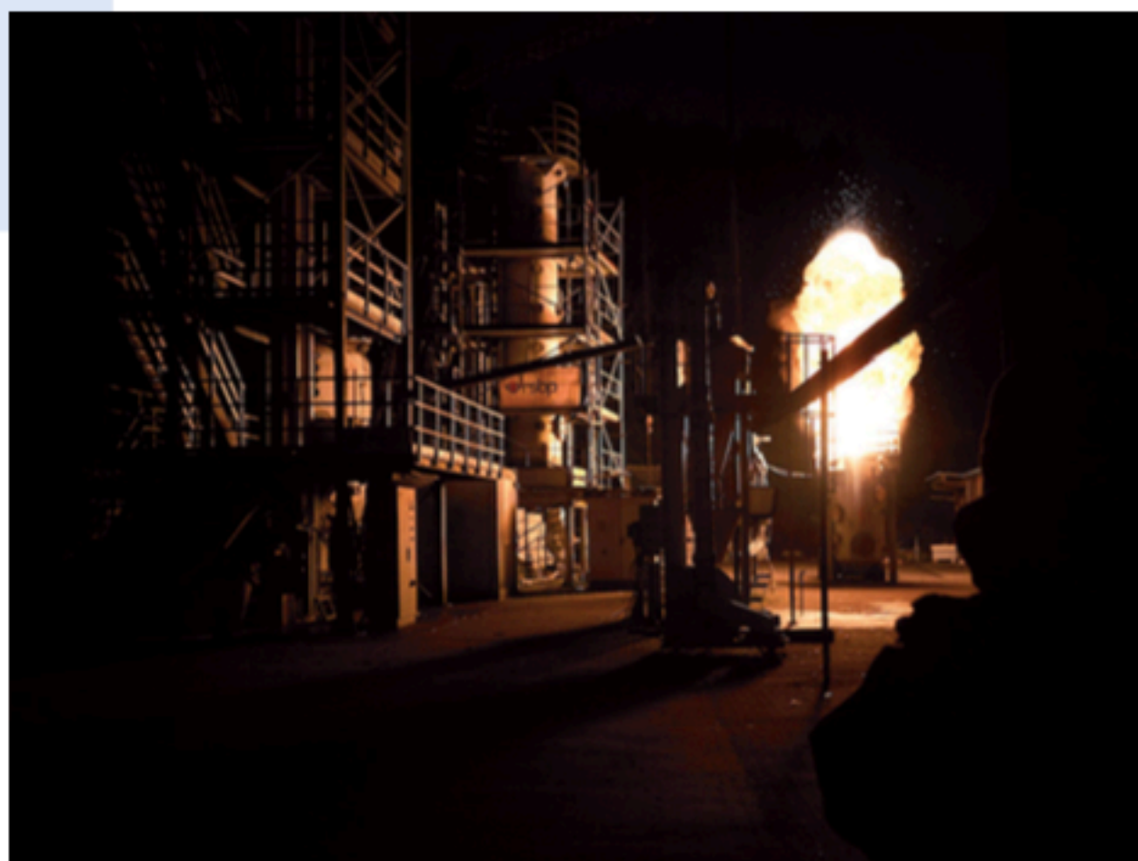
Test di collaudo con esplosione su pannello di rottura (Erigo).
